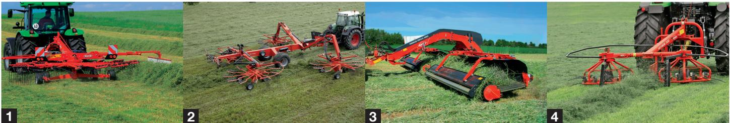
1. Навесные однороторные 2. Полунавесные 4-роторные 3. Валкообразователи с ленточным конвейером 4. Ворошилки-валкообразователи
