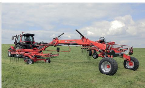
Установите отражатель валка на передний ротор для формирования двух валков
