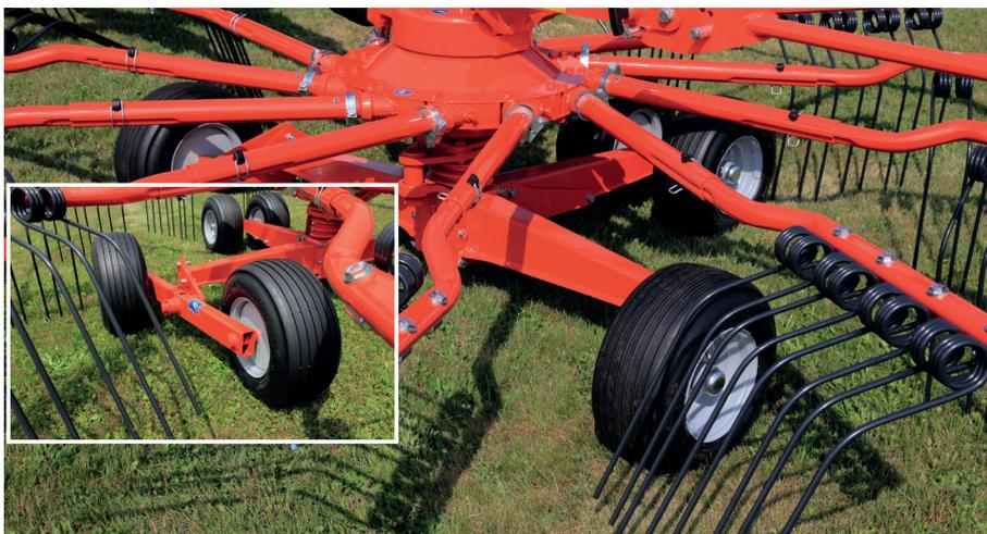
Сдвоенный мост в дополнение к мосту 3D (опция) идеально подходит для управления ротором в трудных условиях (колеи, выпасные луга и т. д.), а также при высокой скорости относительно грунта. В таком случае следует выбрать модель GA 7501+.
