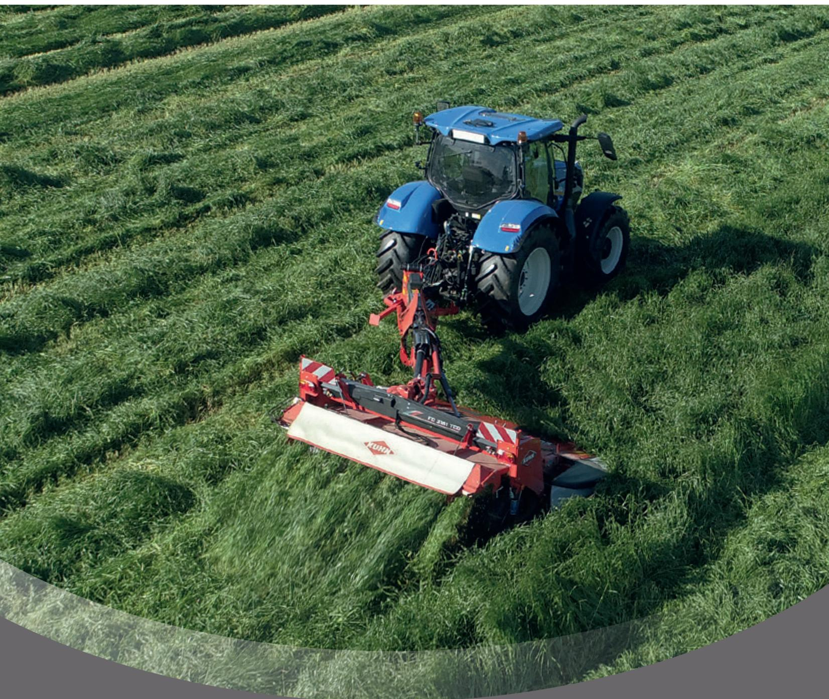
Новое поколение косилок-плющилок FC3161 с новым косилочным брусом **OPTIDISC ELITE** с двухкратным ростом площади перекрытия и двухкратным снижением угла наклона, системой защиты Protectadrive, быстросъемным креплением ножей Fast-fit, а также полиуретановыми катками SQUAREFLEX, которые подходят даже для самых хрупких растений.
