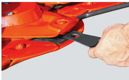
Крепление FAST-FIT: обеспечивается быстрая замена ножей
